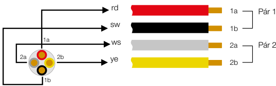
Obr. 2: Star 4 konfigurace s barevným aktuálním značením např. J-Y(St)Y 2x2x0.6 Lg
