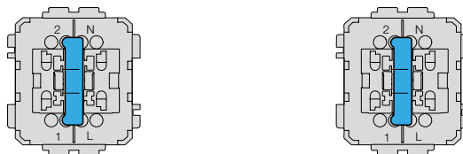
Obr. 5: Podsvícení při vypnutí (orientační podsvícení), křížové ovládání pomocí 2 orientačních přepínačů, LED komplet připojen na svorky 2 - 1
